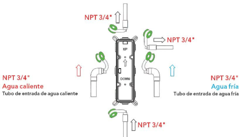
1. Como se muestra en la figura, las tuberías de entrada y salida están pre-enterradas. Por favor, preste atención a la dirección correcta al instalar el cuerpo principal pre-enterrado.
