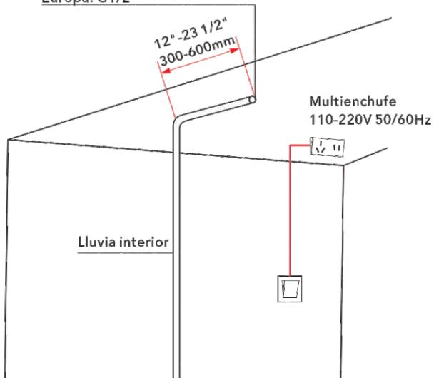
Instale el interruptor de energía en la posición apropiada, disponga la tubería de agua y conéctela al cuerpo principal.
