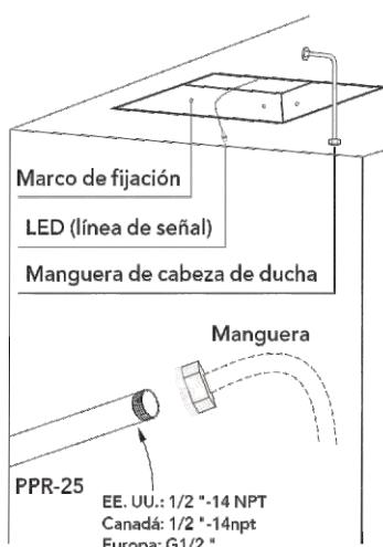
Conecte un extremo de la tubería corrugada al tubería de agua PPR incrustada y el otro extremo para el tubería de entrada de agua en la parte posterior del cabezal de la ducha.
