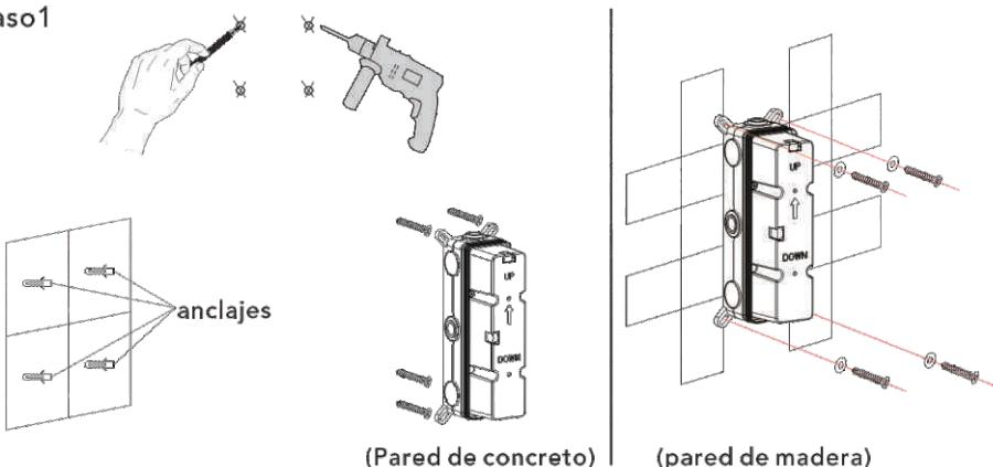
1. Marque según el tamaño de la válvula del cuerpo principal y luego perfore para colocar los anclajes en la pared (pared de concreto).
