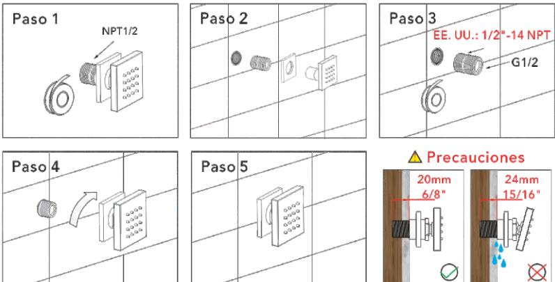
Paso 1: Asegúrese de que el tubo roscado y la cinta de material bruto sean del tamaño adecuado para evitar desalineaciones al atornillar en la pared.
