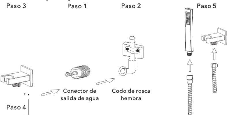
Paso 1. Retire el conector macho de la parte superior del soporte de la ducha (no dañe la junta, de lo contrario, habrá fugas).
