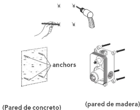
1. Marque según el tamaño de la válvula del cuerpo principal y luego perfora para colocar los anclajes en la pared (pared de concreto).
