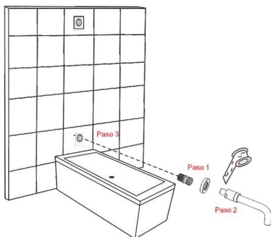
**Paso 1:** Conecte el conector de cobre al grifo de la bañera y envuélvalo con cinta impermeable.
