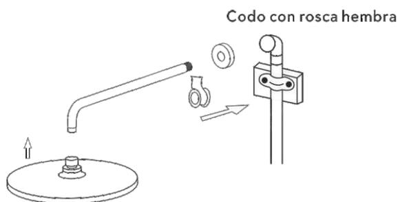
1. Conecte el brazo de ducha con la cubierta antes de atornillar el brazo en la conexión del riser para prevenir daños.
