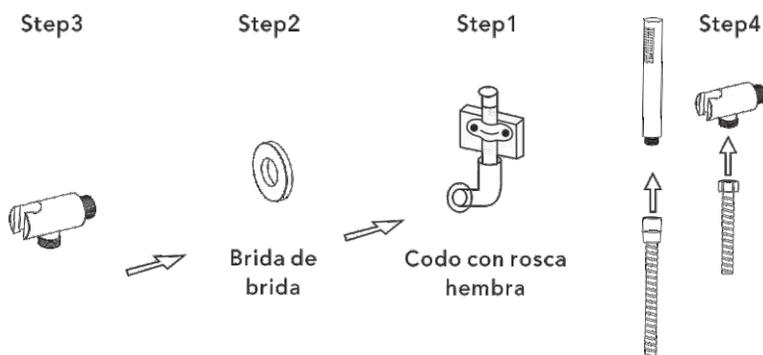
Paso 1: Atornille la rosca en la tubería de agua dentro de la pared.
