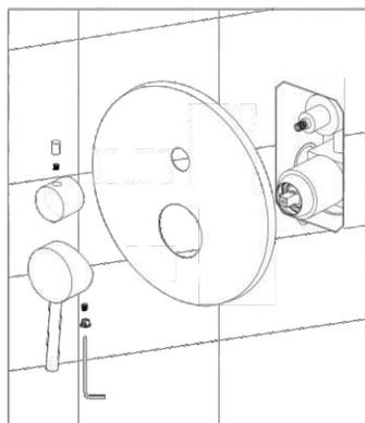
1. Marque según el tamaño de la válvula del cuerpo principal y luego perforo para colocar los anclajes en la pared (pared de concreto).
